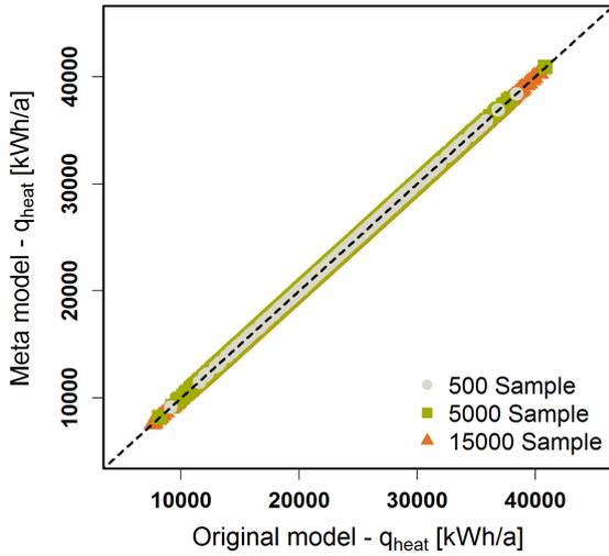
Abbildung 4: Cross validation of the NN- $q_{heat}$
