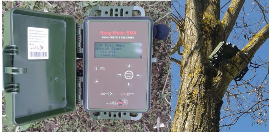
Abb. 3: Akustisches Aufnahmegerät Song Meter SM 4 der Firma Wildlife Acoustics für Vogelstimmen und seine Montage an einem Versuchsbaum in München Riem
