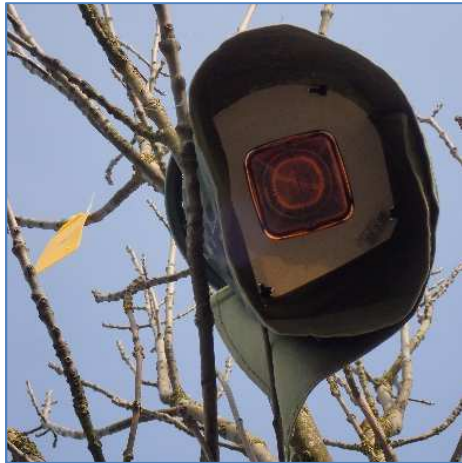
Abb. 2-4 Gelbtafel und Luftelektor in der Baumkrone, Blick von unten aufs Fanggefäß
