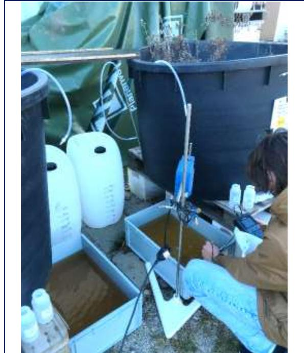
Abbildung 13: Probenahme des Sickerwassers mit pH- und EC-Messung aus den halbtechnischen Versuchen an der TUM
