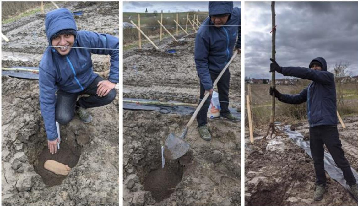
**Abbildung 7.** Positionierung der Bodenfeuchtesensoren unterhalb des Wurzelstocks vor der Baumpflanzung im Frühjahr 2020. Seit Juni 2020 wurden durch Datenlogger Durchschnittswerte in 10-Minuten-Intervallen erfasst.
