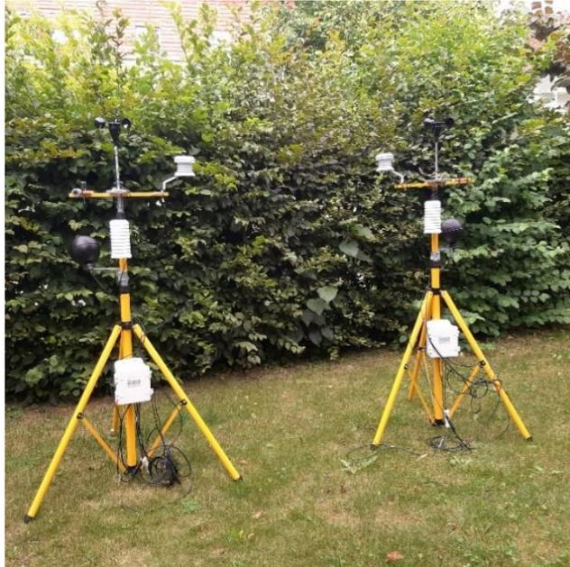
*Abbildung 42. iButton-Sensor-Kalibrierung.*
