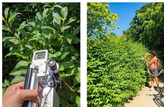
Abbildung 6. Messung der Blatt-Gaswechselaktivitat an ausgewahlten Straucharten (links: Forsythie, rechts: Hainbuchenhecke) mithilfe eines mobilen Gaswechsellmessgerats (Modell Licor LI-6400XT) zur Bestimmung der Kohlenstoffaufnahme und -freisetzung sowie der Wasserdampfabgabe und -aufnahme durch die Blatter.
