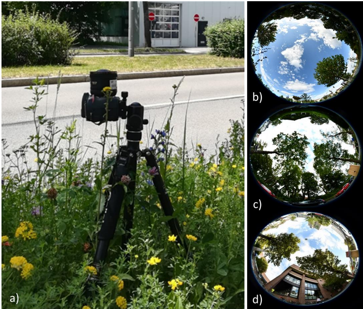
Abb. 6: Die Aufnahme der lokalen Beschattungssituation durch Bäume und Gebäude erfolgte mit einer Digitalkamera und einem Fisheye-Objektiv. a) Die Digitalkamera wurde auf einem Stativ in der Mitte der Versuchsflächen platziert. b) Fisheye-Aufnahme mit geringer Beschattung; c) mit dichten Baumkronen; und d) mit Bäumen und Gebäuden (Fotos: Sandra-Rojas-Botero).
