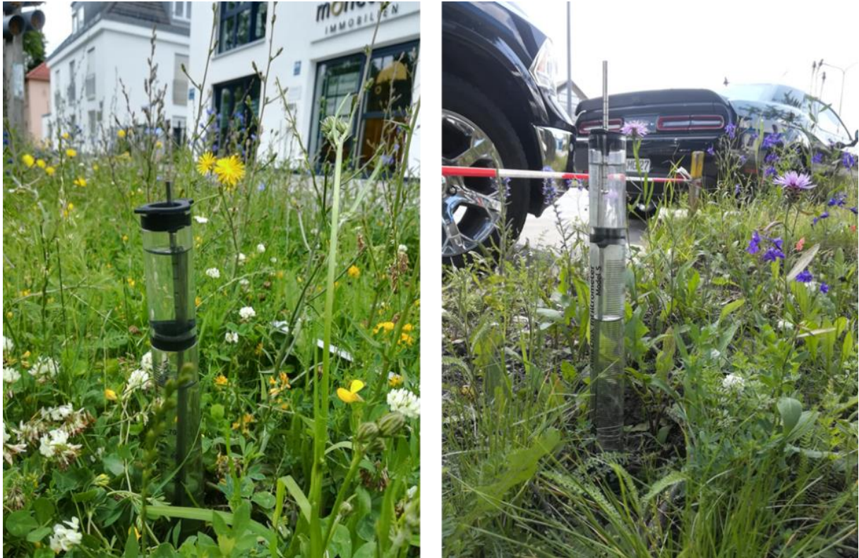
Abb. 7: Infiltrometer zur Messung der Versickerungspotentials der Versuchsflächen (Foto: Sandra Rojas-Botero).
