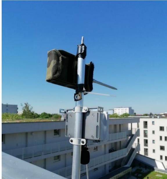
**Abbildung AP2-2:** EcoObs Batcorder (oben) zur Aufnahme von Fledermausrufen und der Soundrekorder Frontier Labs BAR (unten) im Einsatz auf dem Dach in der Brantstraße.
