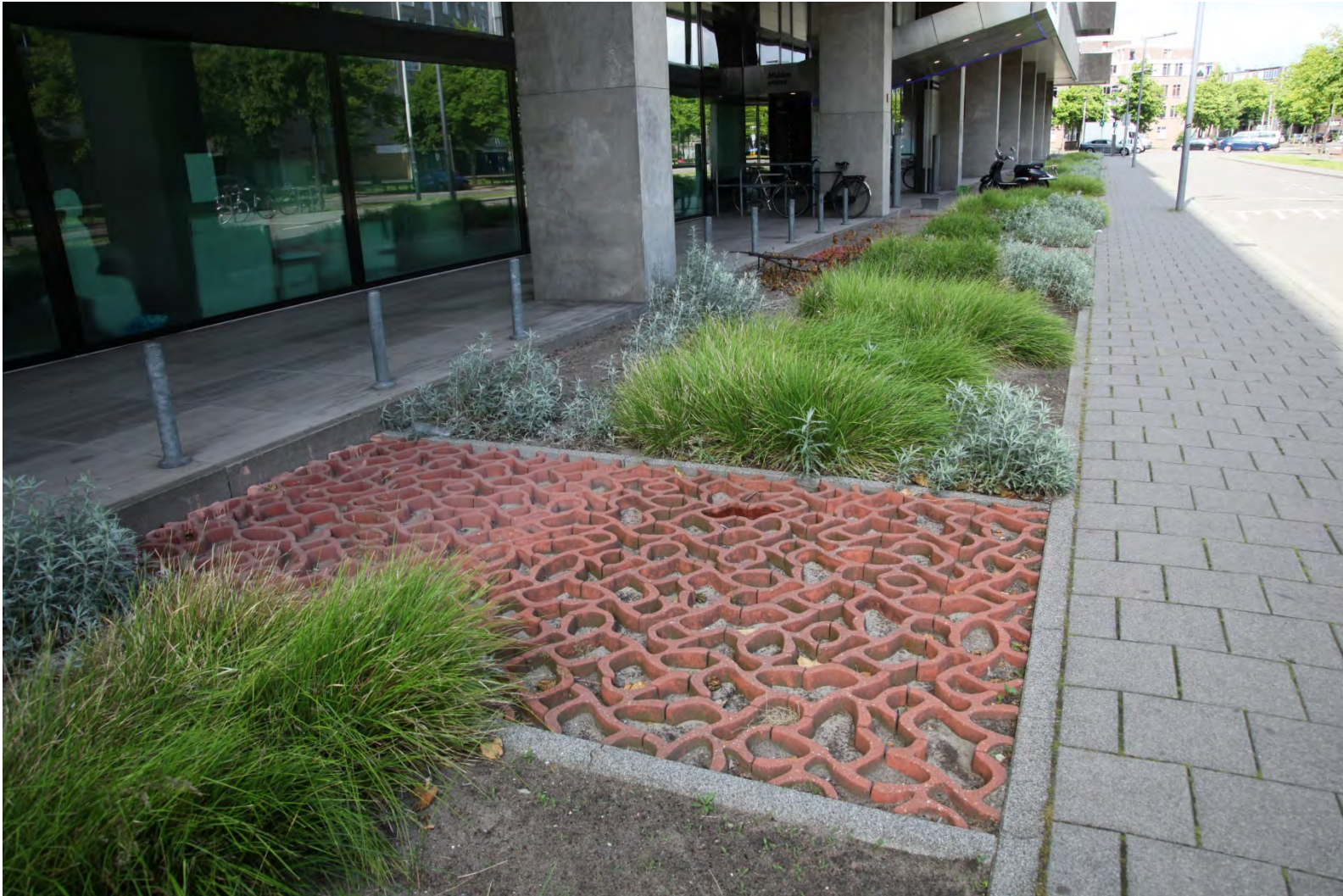
Wasserdurchlässige Beläge Rotterdam, Hofbogen
