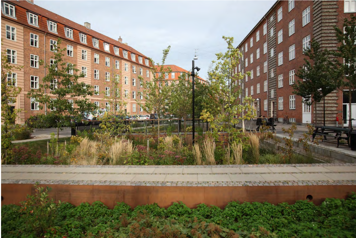
Versickerungsmulden mit Einstaflächen als wechselfeuchter Standort Kopenhagen, Taspne Plads
