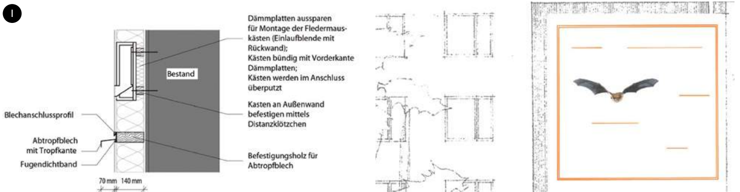
Schnitt Fassadenquartier: Quelle: Architekturbüro Hechenbichler, München
